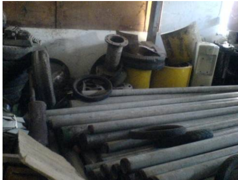
各戸給水管接続用の亜鉛引き鉄板の ストック
