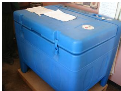
ガス・電気切替式冷蔵庫 （チョンウエのカトリック系病院）
