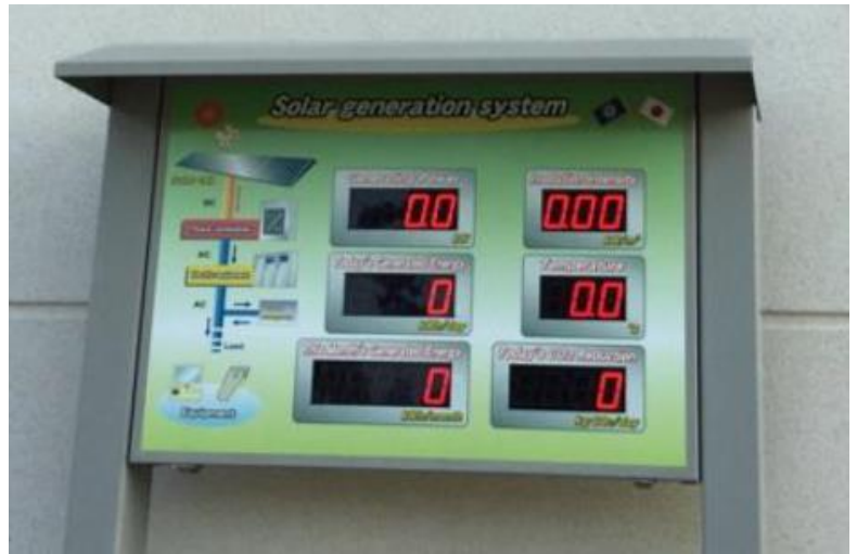
(データシステム故障のためゼロを示すモニター)
