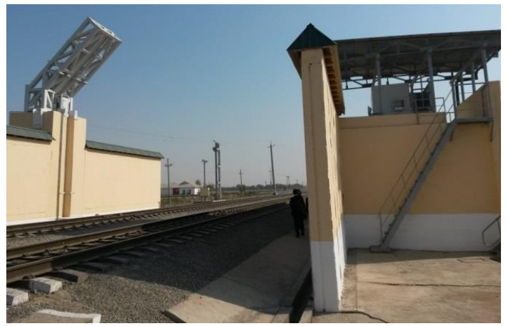
ウズベキスタン - アフガニスタン国境に近いガラバ駅の鉄道用 X 線検査機 (稼働中)
