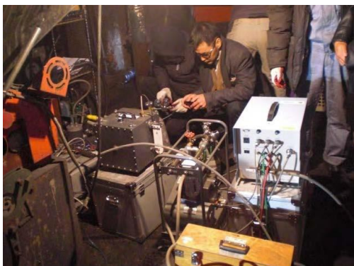
HOB 施設内の排ガス測定の様子
