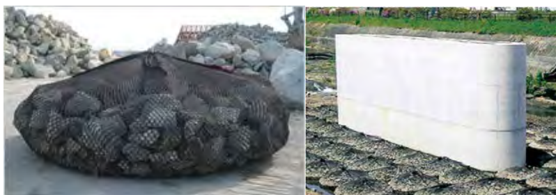
図 2.7.14 洗堀防止用袋型根固め工法用袋材
