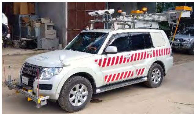
図 2.7.2 路面性状調査車両
