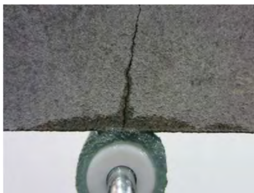
図 2.7.13 塗布・浸透型ひび割れ補修材
