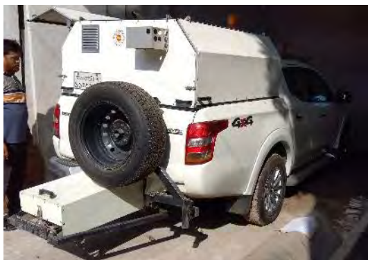
図 2.7.2 路面性状調査車両
