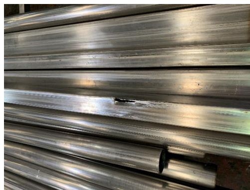
製造過程の傷による不良品 (2022 年 8 月)
