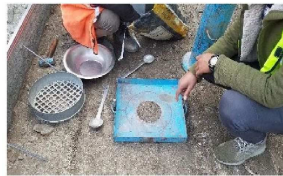
締固め試験 実施状況 (砂置換法)
