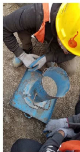
締固め試験 実施状況 (砂置換法)
