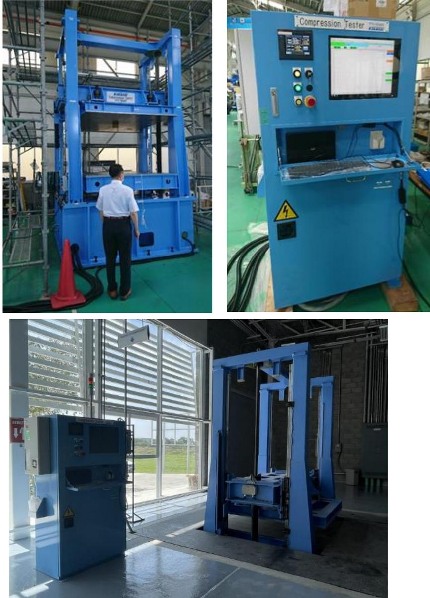
図 24 圧縮試験機外観（本体（左）、制御・操作盤（右）／圧縮試験機外観）
