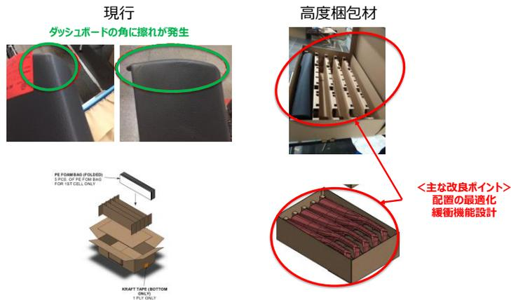
図 65 B 社（ダッシュボード）の比較試験結果
