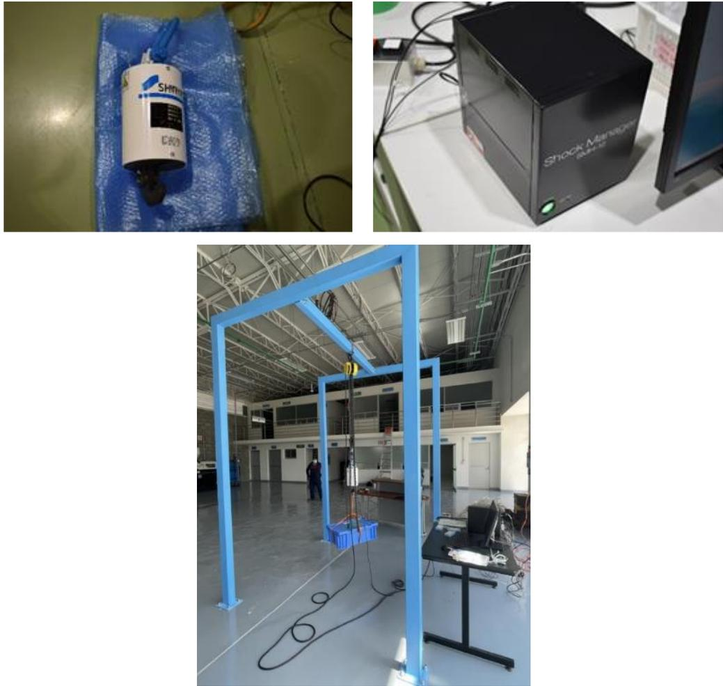
図 25 落下試験機外観（電磁フック（左）、ショックマネージャ（右）／落下試験機）
