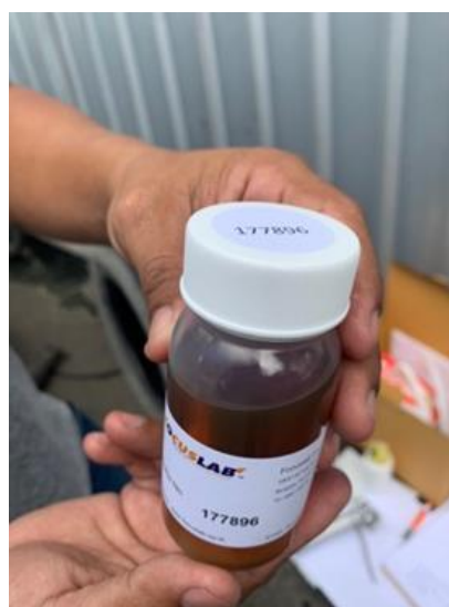
写真 8 エンジンオイルのサンプリング
