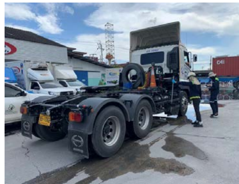
大型トラック（トレーラー）で黒煙試験
