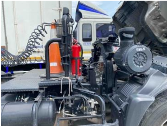
写真4 トレーラーへのPECS装着
