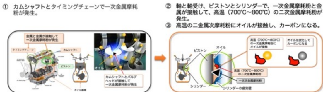
図7 二次金属摩耗粉とカーボンの発生メカニズム
