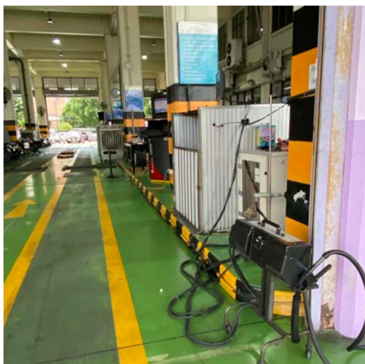
写真 12 DLT の検査場 手前右が黒煙測定器
