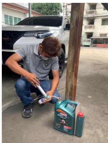
写真 8 エンジンオイルのサンプリング
