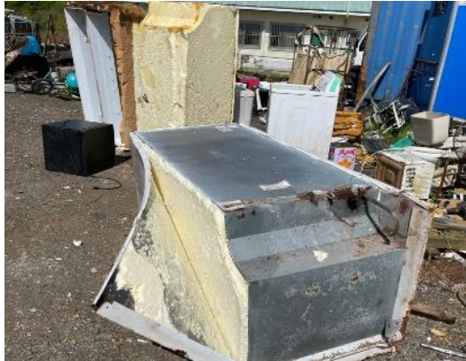
フロンを含むコンプレッサーが抜き取られ、断熱ウレタンがむき出しとなった冷蔵庫
