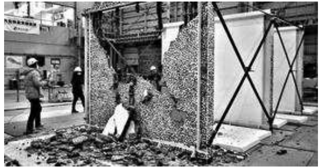
写真 14 2022年1月に日本のつくばで行われた振動台実験では、4インチ CHB（無構造・無負荷）でできた CHB 壁が倒壊したのに対し、同じ壁にアスターの Power Coating を施したものはひび割れもなく静止していることが確認された
