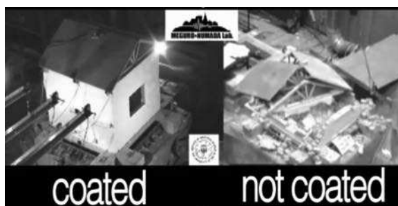
(東京大学生産技術研究所における振動台実験)
