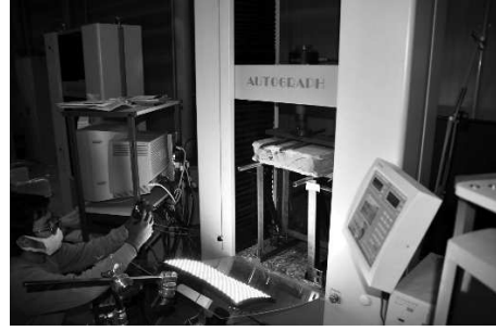
ラボテスト@東京大学 (面外曲げ試験)
