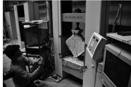
ラボテスト@東京大学 (面内斜めせん断試験)
