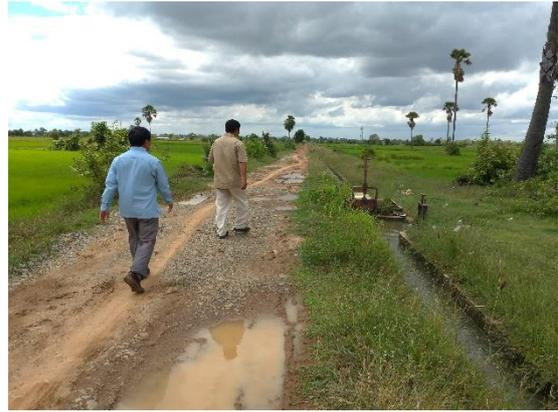
写真-18 写真-15と同じ地区内、3次水路沿いの農道は幅3mだが、トラクターが普及してきたことにより5mが望ましいとのこと
