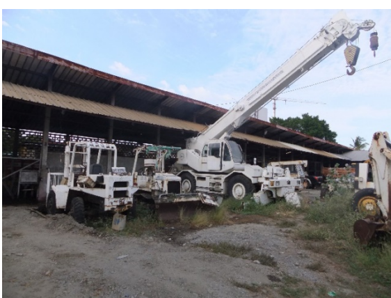
IGE 本部、2022年5月 自衛隊供与の老朽化した建設機材。既にスペアパーツが製造されておらず、修理が困難。
