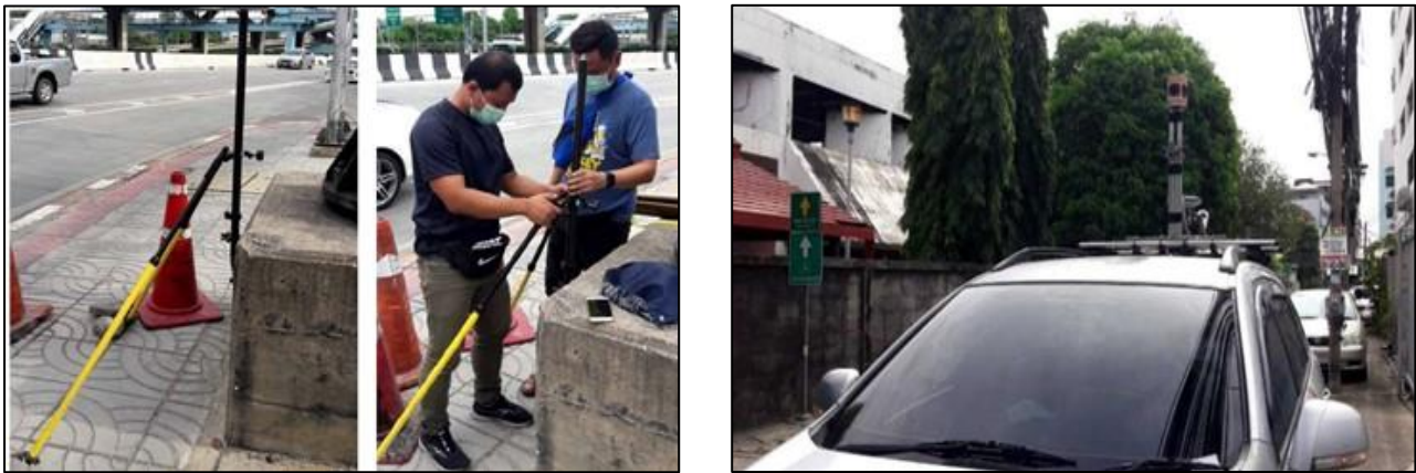
写真 2 : GCP 計測作業及び MMS 計測機材 (2021 年 6 月撮影)
