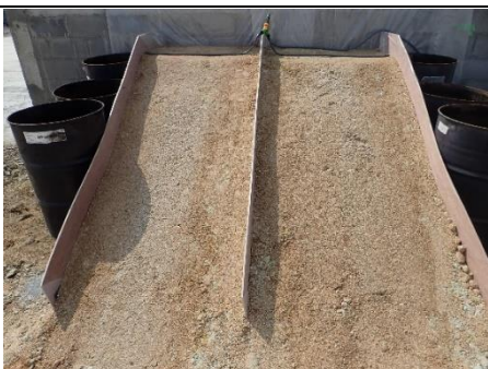
土壌水分センサーを用いた実験盛土
