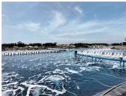
図 8 水車、ナノバブル、攪拌機を利用した養殖場
