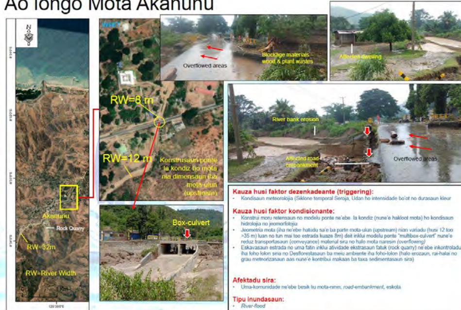
図 3.5-24 Akanunu 川と国道 1 号交差部の被災状況
