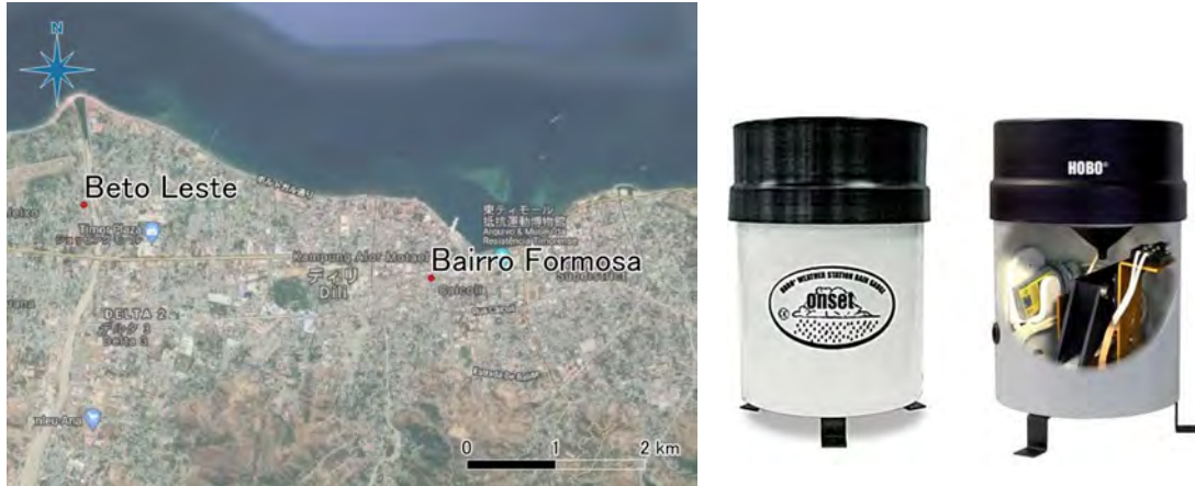
図 3.1-7 時間雨量観測地点と使用機器
