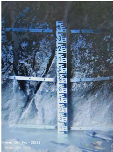
図 3.1-4 ANAS の水位観測地点及び水位観測の例
