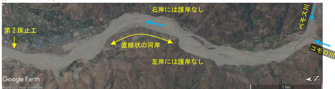
図 3.2-49 河道の変遷：第2床止工～ベモス川合流点（2005/9/7）
