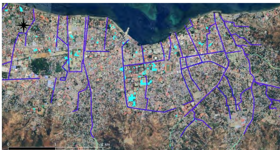
図 3.5-3 AW3Dより抽出した中心部の窪地と既設排水路網
