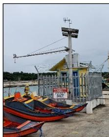
写真2 津波検知器
