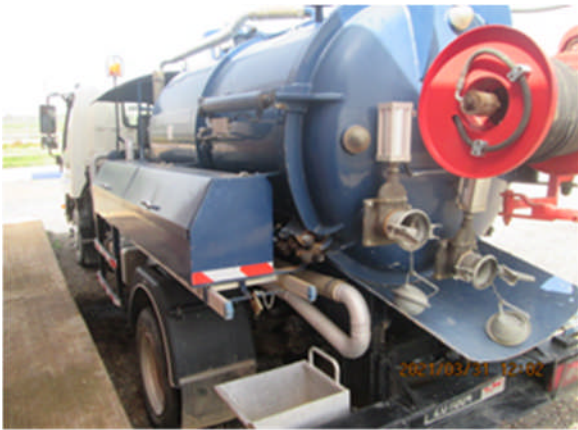
写真3：下水管清掃機材 (エル・ケラ・デ・スラグナ市)
