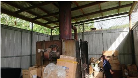
2022年2月時点で利用されている医療廃棄物用焼却 炉 (ラバウル)
