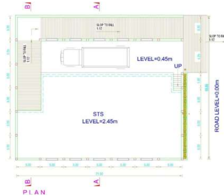
スロープ搬入・投下タイプ (リキシャバンは道路より 2.45m 上のステージに上りトラックにゴミを投下)
