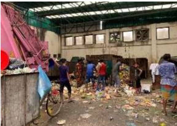
STS 内ではサイズが異なるコンテナが置かれ、リキシャバンから手作業でコンテナに積み替えられる。作業は非効率であり、ゴミは一面に飛散している。
