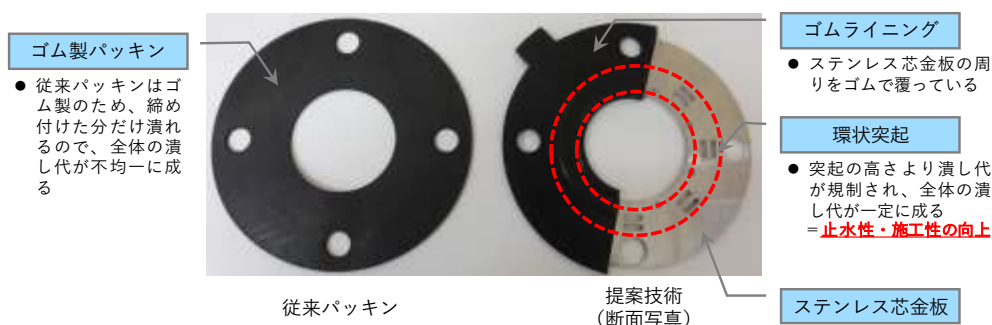
図 4 LSP フランジ結合補強具の構造
