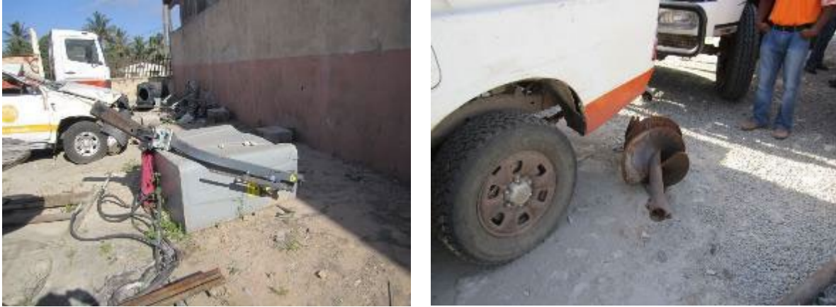
図 6.2-17 EDM のクレーン付トラックに取付けるバケット（左）とオーガー（右）
