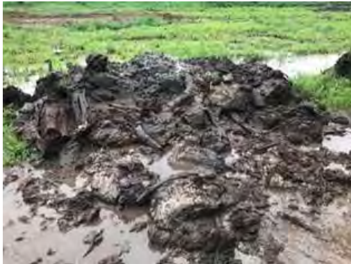
試掘状況 STA8+600 付近 木片多数が存在
