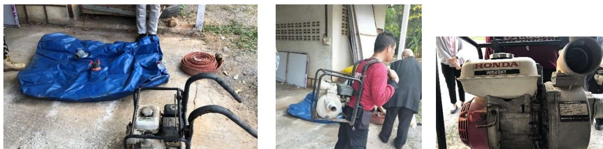
写真 4 背負い式可搬消防ポンプと周辺機材（貯水バッグ、ホース） 出典：調査団撮影
