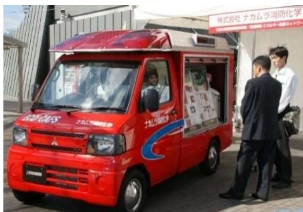
写真 17 山間・僻地や狭い住宅地に適するようにコンパクト化した軽自動車タイプの CAFS 装置付き化学消防車「ECO CAFS mini」
