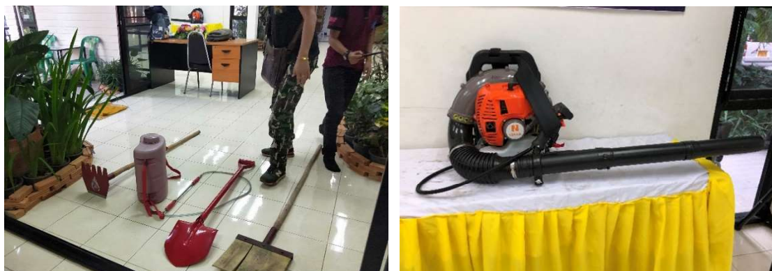
写真 2 森林火災管理事務所の消火機材（左より鍬、小型放水機、シャベル、はたき）、送風機 出典：調査団撮影
