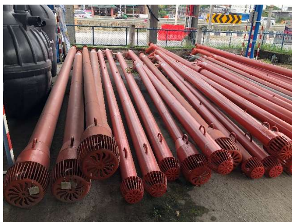
写真 43 (右) 農業用の送水機能付きパイプ
