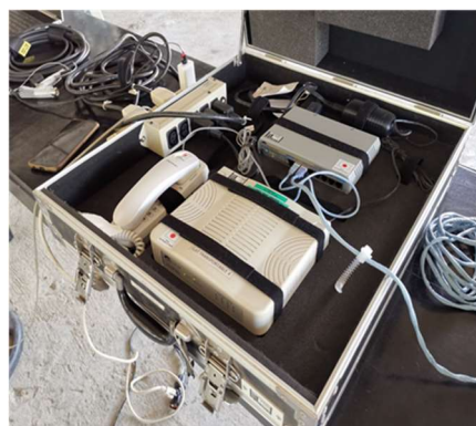
緊急時用可搬型 VSAT
