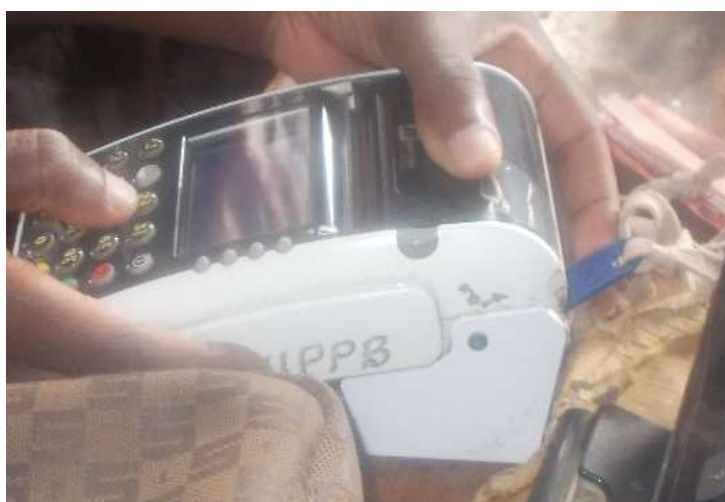
図 4. ハンドヘルドデバイス（決済用課金携帯端末）を介してトークンにクレジット（前払い額）をロード（課金）する
