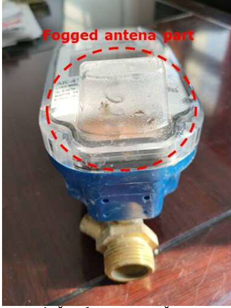
الصورة 10.1: تشكل "GK" لشاشة العداد دفع الماء نتيجة تآكل مياه.
