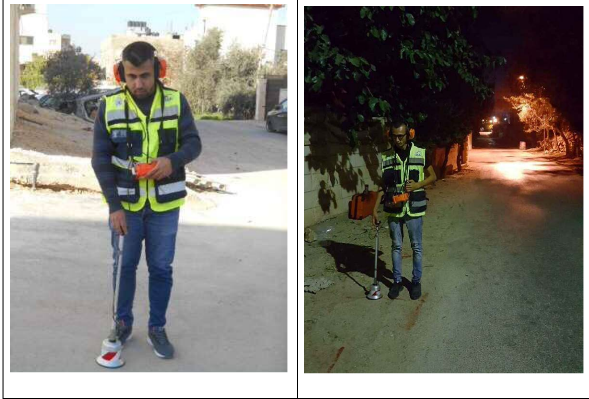
الشكل 22: مسح تحديد الخط باستخدام المايكروفون الأرضي ( Ground Microphone )
