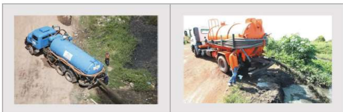
図 23：不適切な方法で汚泥を投棄するピット清掃トラック
