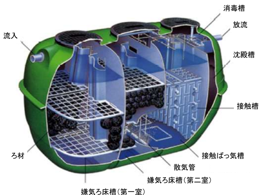
図 28：典型的な浄化槽システムの図解
