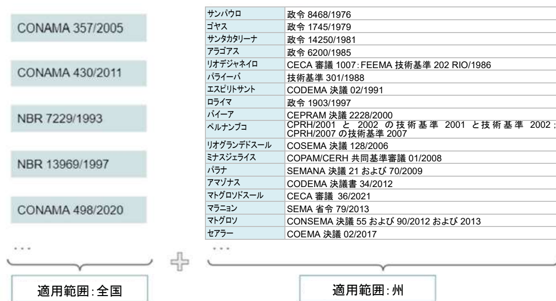
図 8：下水処理水の放流パラメーターに関する連邦および州レベルの技術基準
