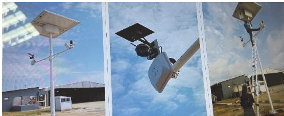
図 7-3 貨物トラックのモニタリングで用いられている RFID アンテナ
