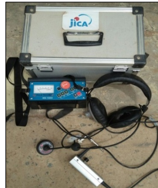
本事業の供与した漏水探知機
