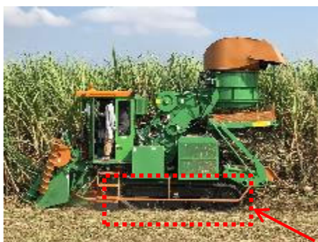
ゴムクローラのため接地圧が小さい
