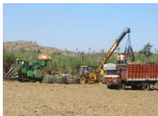
圃場内のクレーン・トラック利用の積込み作業
