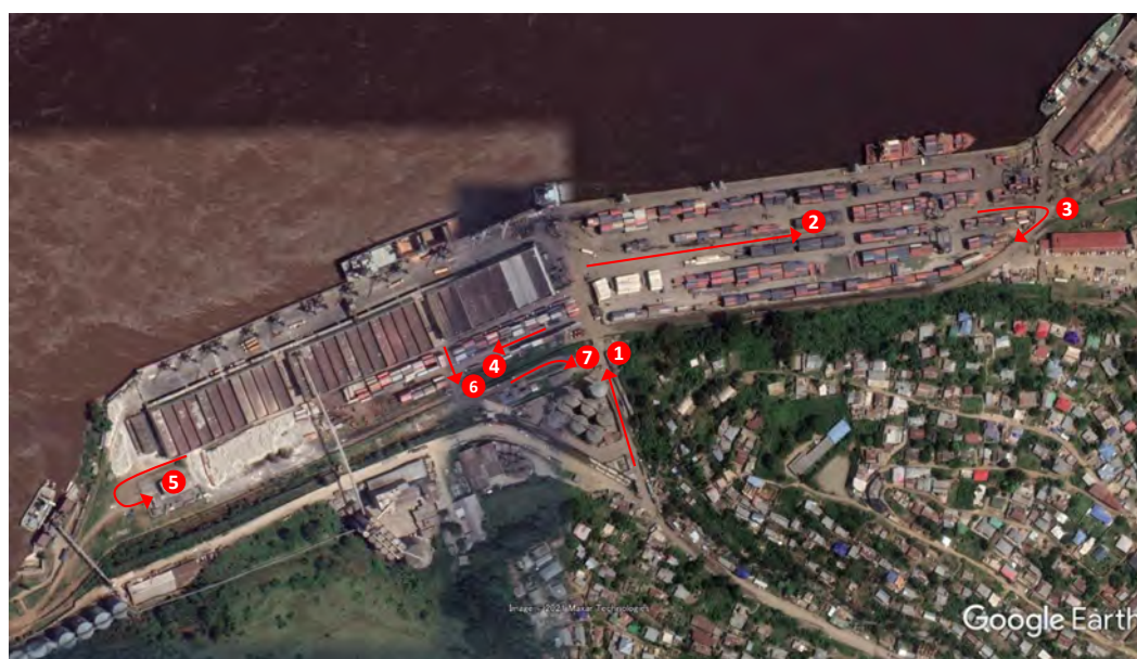
図5-6-2 輸入におけるトレーラーの動線
