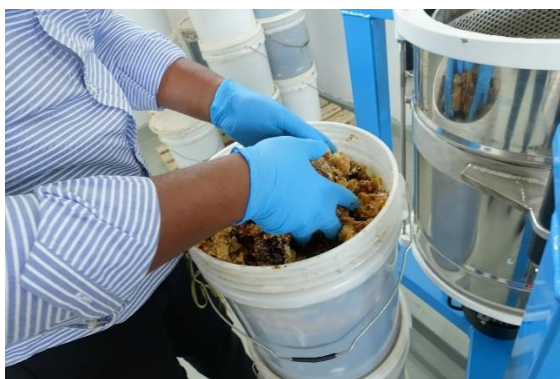
Swahili Honey 社工場ではバルク状態で養蜂家よりはちみつを買い上げてくるが、コームも混ざった状態（左上）。買い付けてきたはちみつを遠心分離機で不純物を分ける（右上、左下、右下）。
