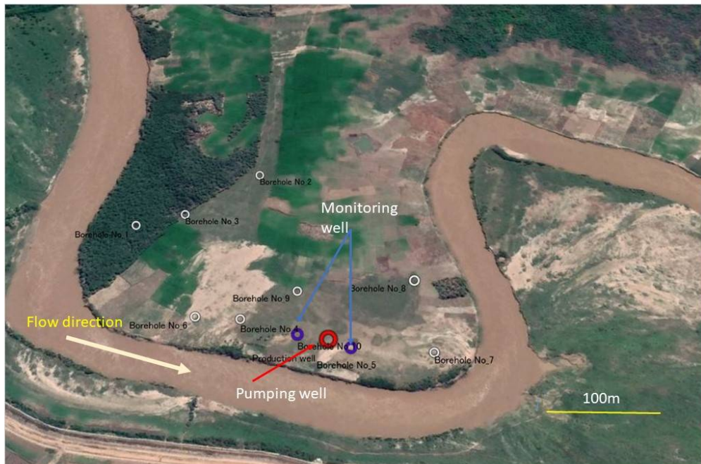
図 3-5 揚水試験レイアウト（揚水井戸と観測井戸位置）
