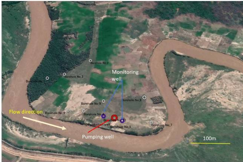
図 10.2-8 揚水試験レイアウト（揚水井戸と観測井戸位置）
