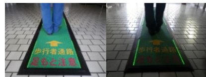
道路工事用マット型『発電床®』 （左：周囲明るい、右：周囲暗い）
