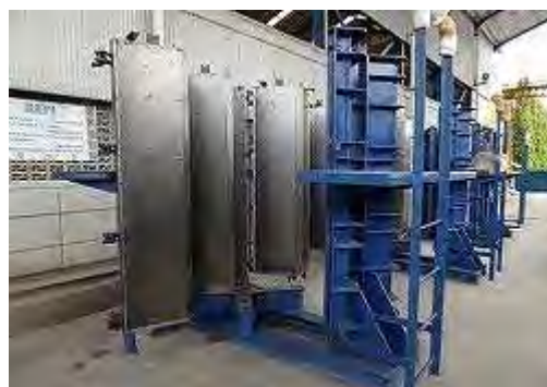
柱材+型 型枠配置状況
