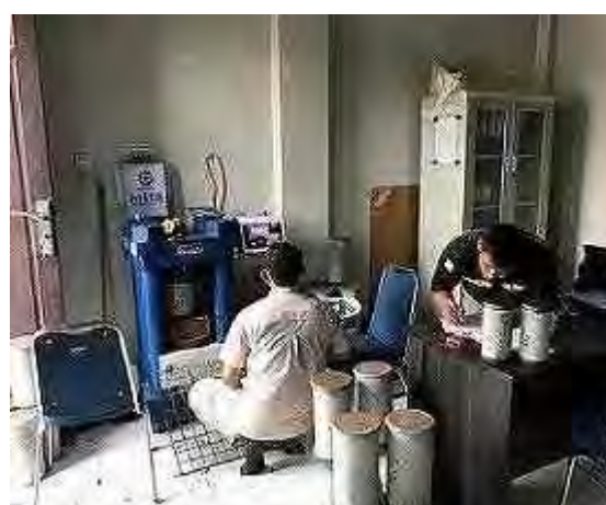
【第6回渡航 圧縮強度試験】
