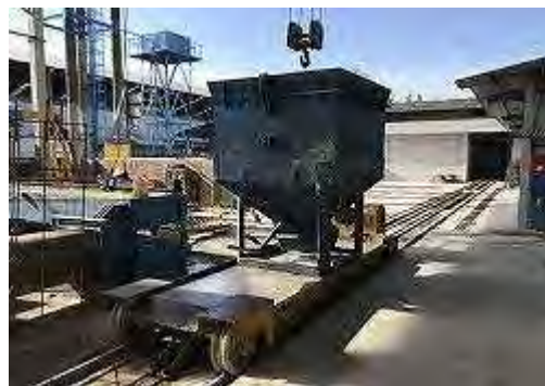
製造設備コンクリートホッパー
