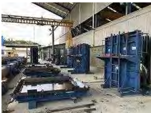
型組状況 頂版スラブ
