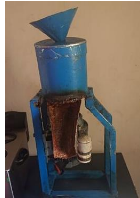
Joble Enterprise で製造しているピーナツバター製造機
