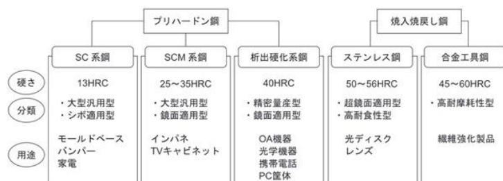
図 12 各種プラスチック金型材料の用途一例
