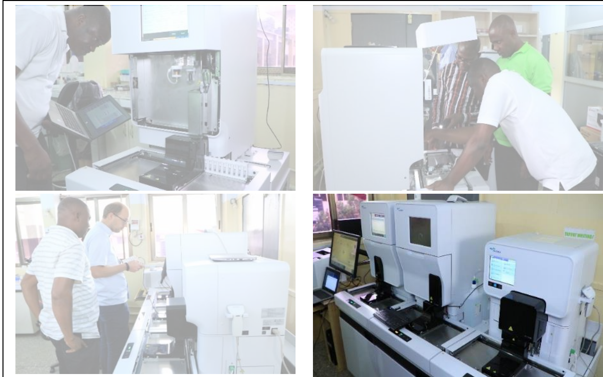
対象製品「全自動尿検査総合搬送システム」の設置作業の様子
