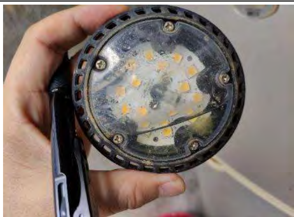
ダラット市内のキク農家で使用される韓国製 LED 電球。内部に水がたまり故障している（ラムドン省ダラット市、2020年11月19日）
