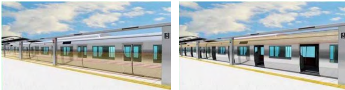
図 8-12 昇降式ホームドア(左:降下時、右:上昇時)
