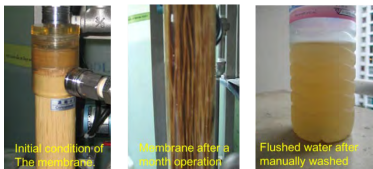
図 6 水道水濾過前後の精密濾過膜と、膜フラッシング水の状態
