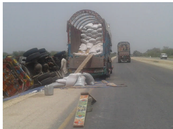
写真 4：積載量超過による事故の様子
