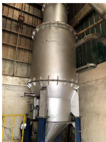
図 1-19 粃殻炭化機材 (NFOTeC)
