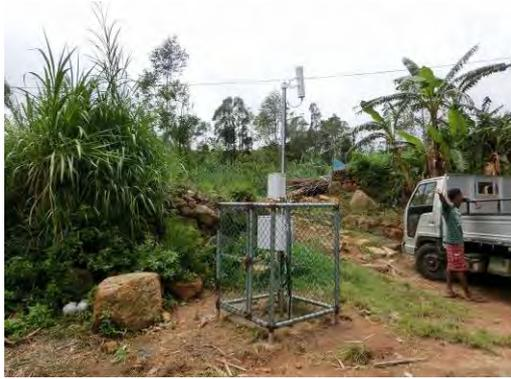
パイプひずみ計・地下水位計
