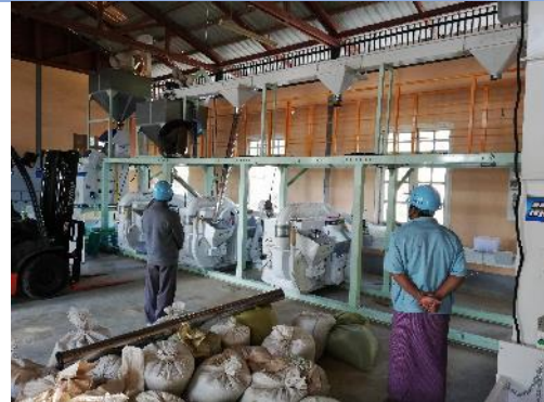
中央が脱ぶ機で、脱ぶされたハトムギは奥にある色彩選別機に流れる（2019年11月26日、タンボジセンター、ニャウンシュエ）
