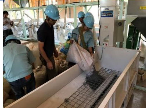
ワイドホッパーの稼働確認 (原料投入) (2019年11月27日、タンボジセンター、ニャウンシュエ)
