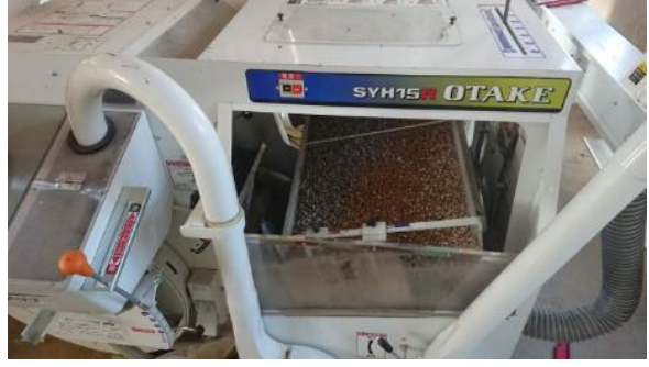
脱っぶ機の選別調整及び管理方法の説明(2019年11月27日、タンボジセンター、ニャウンシュエ)
