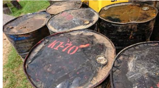
シール舗装に使うアスファルト乳剤
